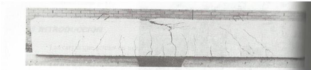
Figura 3 - 14. Fisuras de flexión en la zona de tensión y de aplastamiento en la zona de compresión de una viga simplemente apoyada experimentada por (Nawy, 1998).
